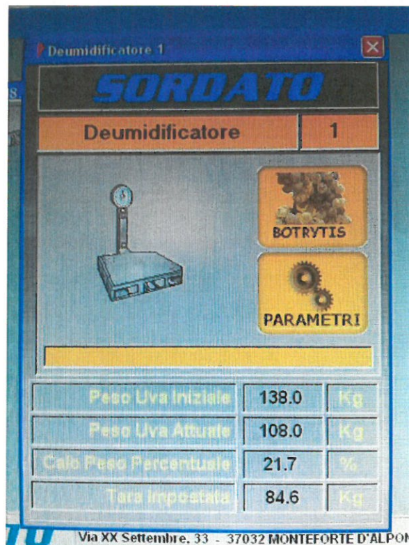
Particolare dell'interfaccia del software indicante il calo peso percentuale
