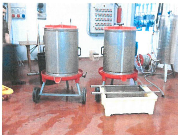
Particolare dei torchiotti a pressa pneumatica utilizzati dopo pigiatura del Semillon
