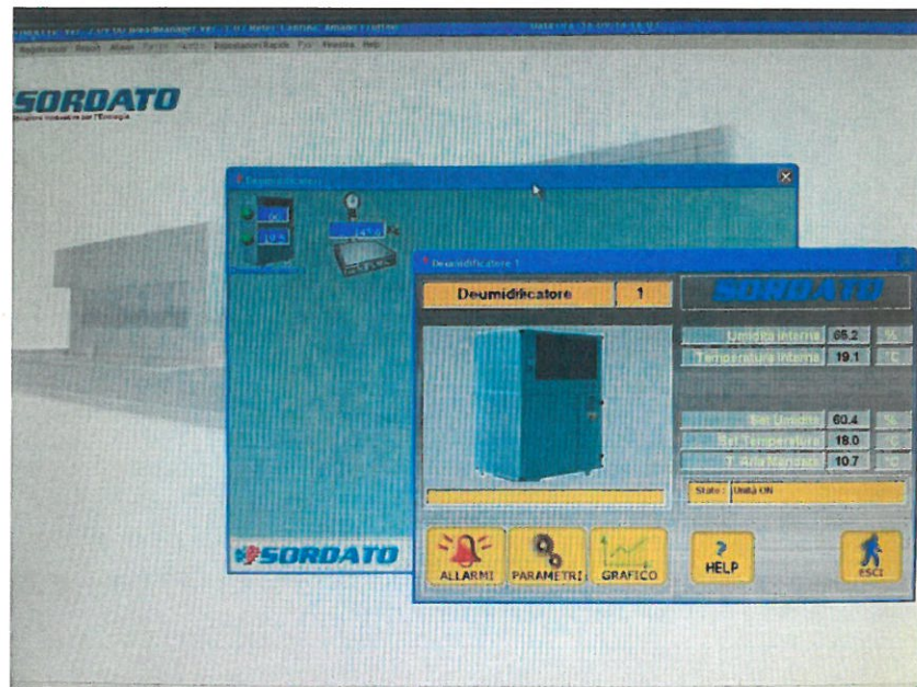
Particolare dell'interfaccia del software per le condizioni interne di temperatura ed umidità
