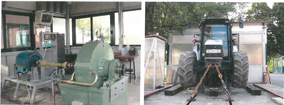
Fig. 1 – A sinistra: sala prove con freno dinamometrico elettromagnetico integrato con un motore elettrico da 30 kW sensibilizzato con cella di carico per il rilievo delle potenze richieste dalla trasmissione; a destra: trattore collegato al freno dinamometrico per le prove, sollevato da terra
