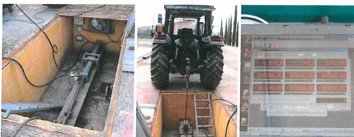
Fig. 3 - Banco prova sollevatori idraulici. A sinistra: impianto idraulico. Al centro: il trattore Lamborghini Premium 1050 durante le prove. A destra: esempio di schermata dei dati rilevati (la finestra in altro a sinistra indica il valore del carico sollevato. La lettura indicata è di 1076 daN)
