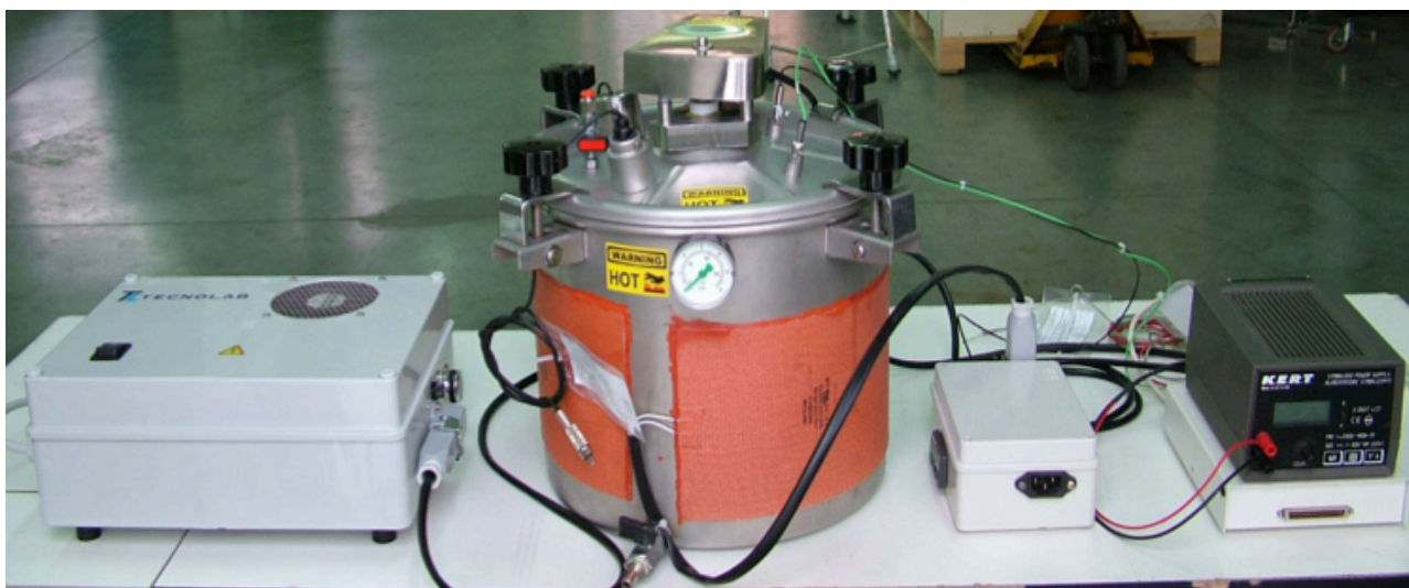
Figura 7.3.1 – Impianto pilota di digestione anaerobica.
