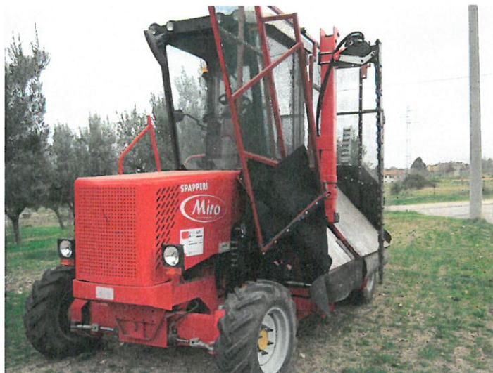
**Fig. 44 – Il prototipo MIRO *Double System* con montata la barra per la potatura - Azienda Agraria Antinori Scarl**
