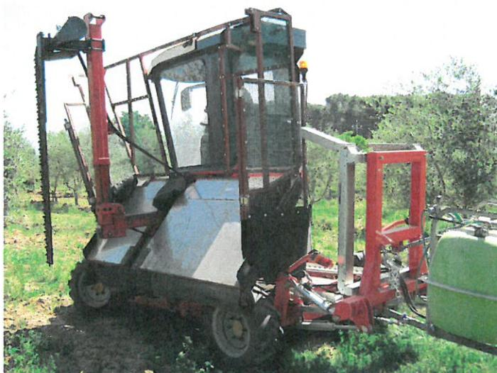
**Fig. 52 – Il prototipo MIRO *Double System* con montata la barra per la potatura - Azienda Agraria Antinori Scarl**
