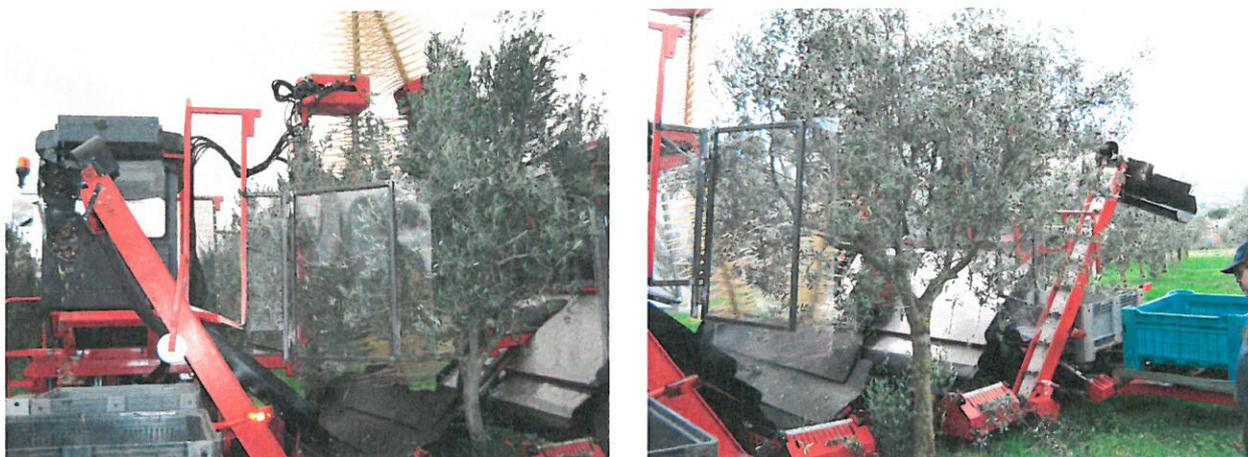
**Fig. 3 – 4 – 5 – 6 – Raccolta condotta con il prototipo MIRO *Double System* su impianto intensivo classico maturo allevato a vaso (5 m x 5 m)**
