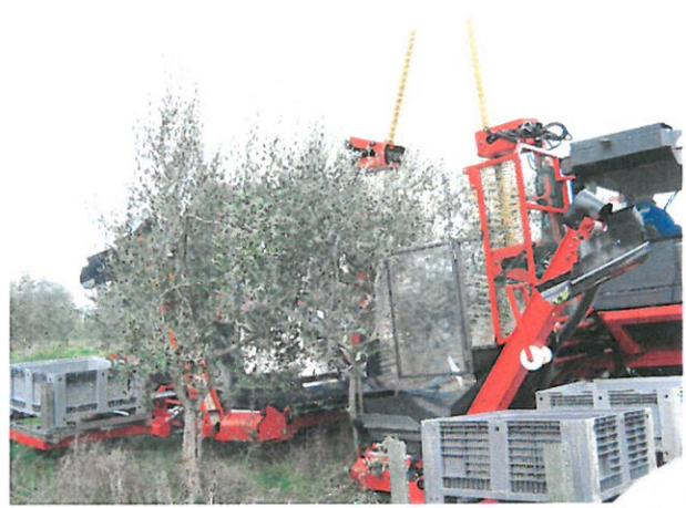
**Fig. 15 – 16 – 17 – 18 – Raccolta condotta con il prototipo MIRO *Double System* su impianto intensivo ad alta densità giovane allevato a vaso (7 m x 2 m)**
