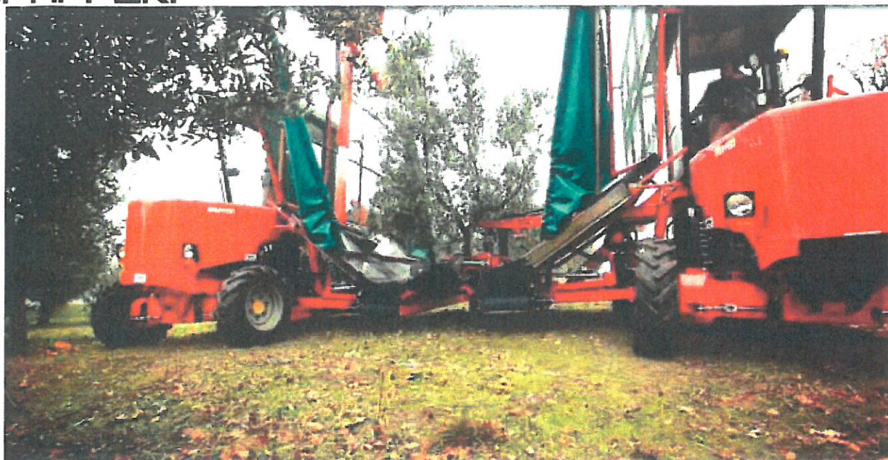
Miro in configurazione raccolta oliva con pinza vibrante.
