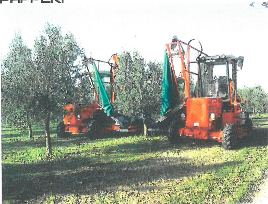
Miro in configurazione raccolta oliva speculare con bacchiatori.
