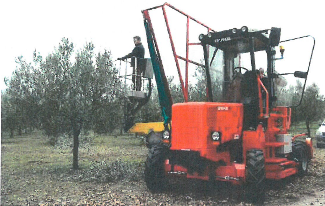
Miro in configurazione con cestello per potatura manuale.
