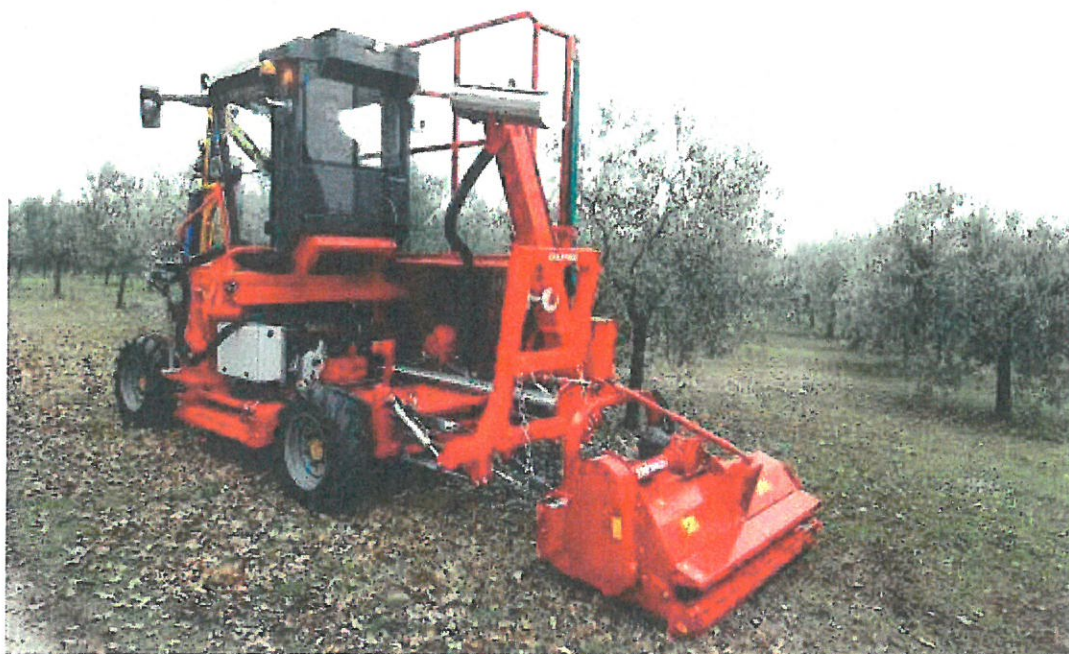
Miro in configurazione con trincia sarmenti
