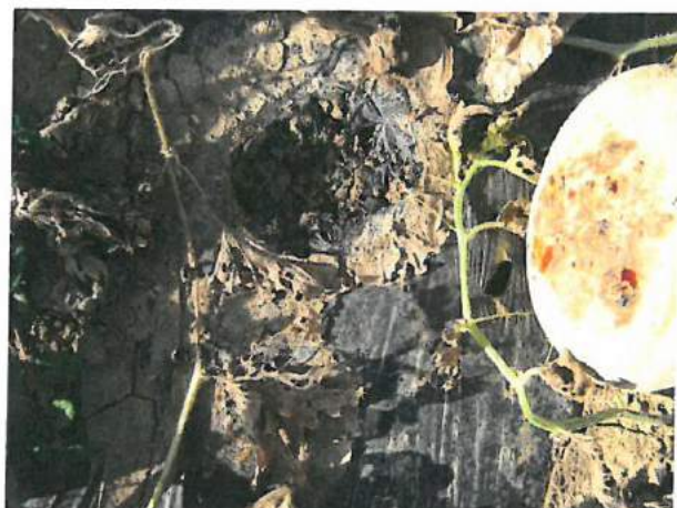
Fig. 60 – 61 Degradazione dei teli “Bio” sotto i frutti in accrescimento (N BIO 12 – N BIO 15)
