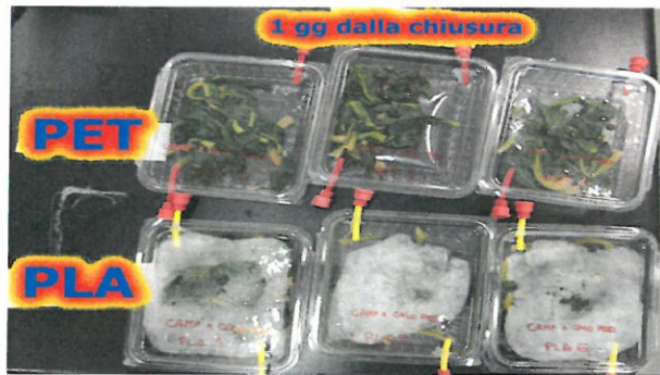
Fig. 17 b – Comparsa di condensa sulla parte superiore delle confezioni di spinaci cotti in PLA dopo 1gg. dal confezionamento
