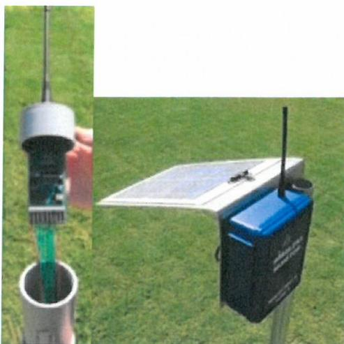
Figura I-6: Nodo WMT-950 (a sinistra) e base ricevente WMR-950 (a destra)
