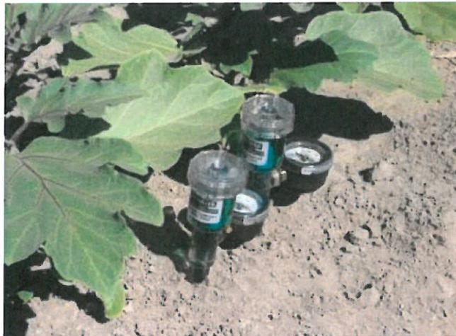
Figura I-15: Tensiometri Irrrometer con manometro a lettura manuale
