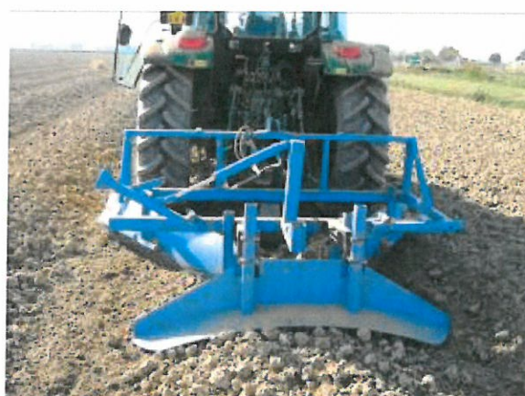
Fig. 4 - 5 – Particolare della baulatrice in azione
