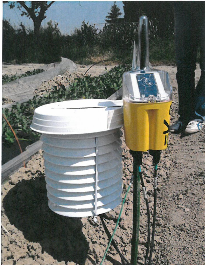
Figura II-6. Schermo per la rilevazione della temperatura dell'aria
