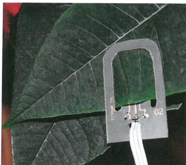
Figura II-3. Esempio di prototipo di sensore-pinza inserito sulla foglia di una pianta sempreverde
