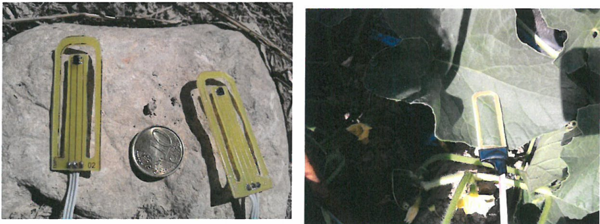
Figura II-5. Sensori-pinza ed esempio di installazione sulla foglia di melone
