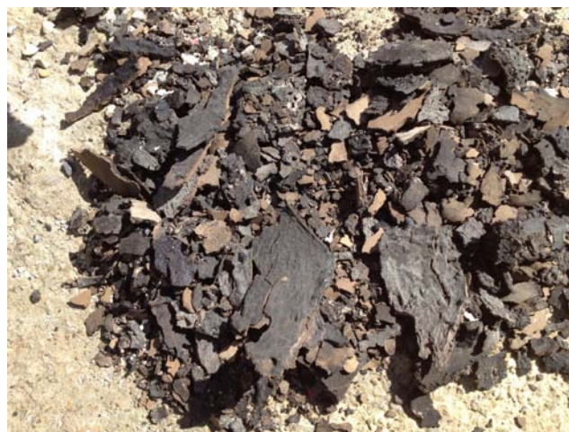
Incrostazioni staccate dal fondo di un serbatoio di ricircolo di osmosi inversa
