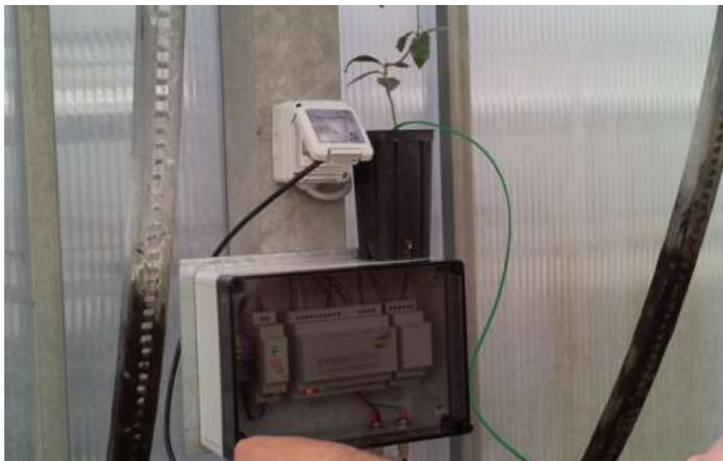
Figura 21 - Box acquisizione dati ambientali all'interno della serra tartufigena 3
