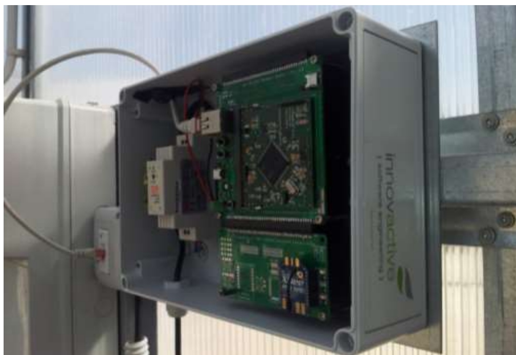
Figura 22 - Box gateway all'ingresso della serra tartufigena 3
